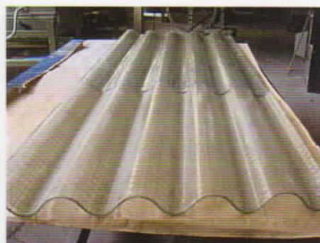
Das Ergebnis überzeugte: Vorn das Original „Wellith“, hinten das Welldrahtglas aus der Freericks-Produktion.
